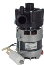
247.90.0504 Motor lavavajillas 901 DX. 0,1 HP. 230V. 50Hz. Giro izquierda. Mod. B-10,11,12.
