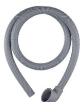
083.00.0501 Longitud 1.500 mm . Ø Tubo 30 mm Ø INT. BOCA 90° 47,0 mm. Ø INT. BOCA 180° 25,0 mm.
